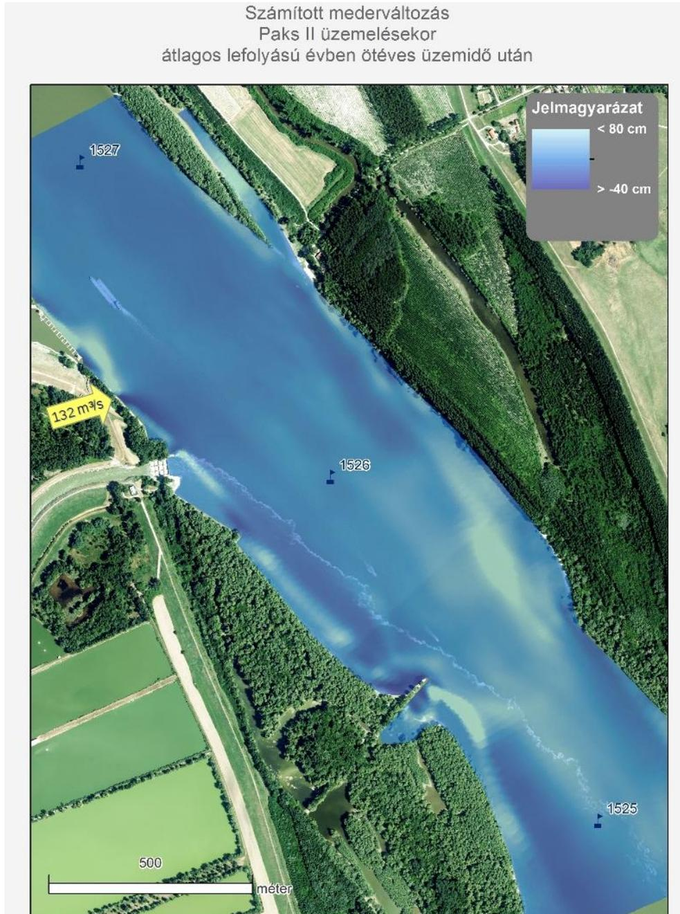
Számított mederváltozás Paks II üzemelések átlagos lefolyású évben öt éves üzemidő után – Calculated morphology changes during operation of Paks II in average hydrological year after five years of operation
