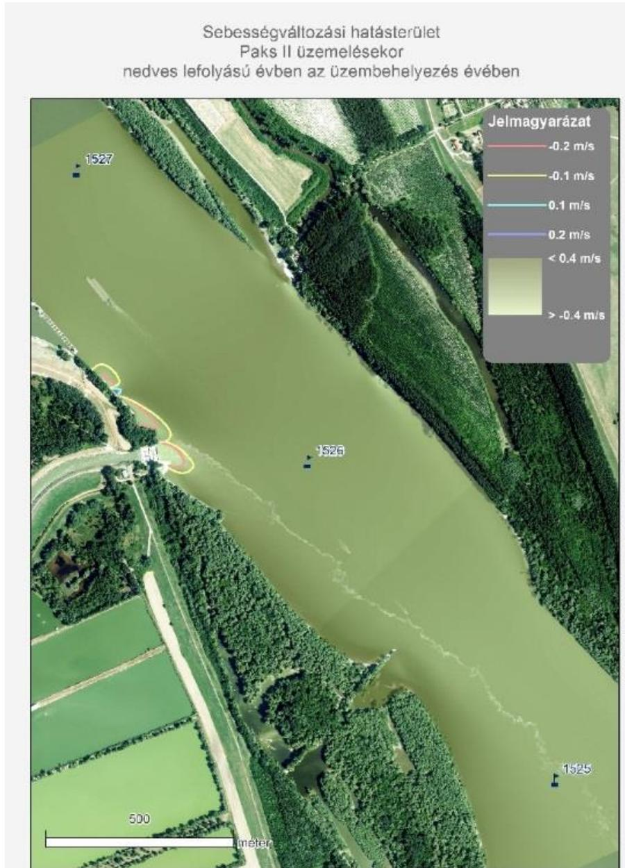
Sebességváltozási hatásterület Paks II üzemelése esetén az üzembehelyezés évében – impact area of flow rate changes on the River Danube during the operation of Paks II in the year of commissioning, in wet hydrological year
