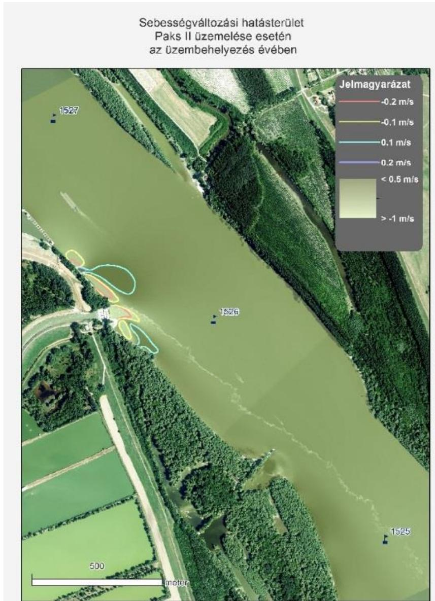
Sebességváltozási hatásterület Paks II üzemelése esetén az üzembehelyezés évében – impact area of flow rate changes on the River Danube in the case of the operation of Paks II in the year of commissioning
