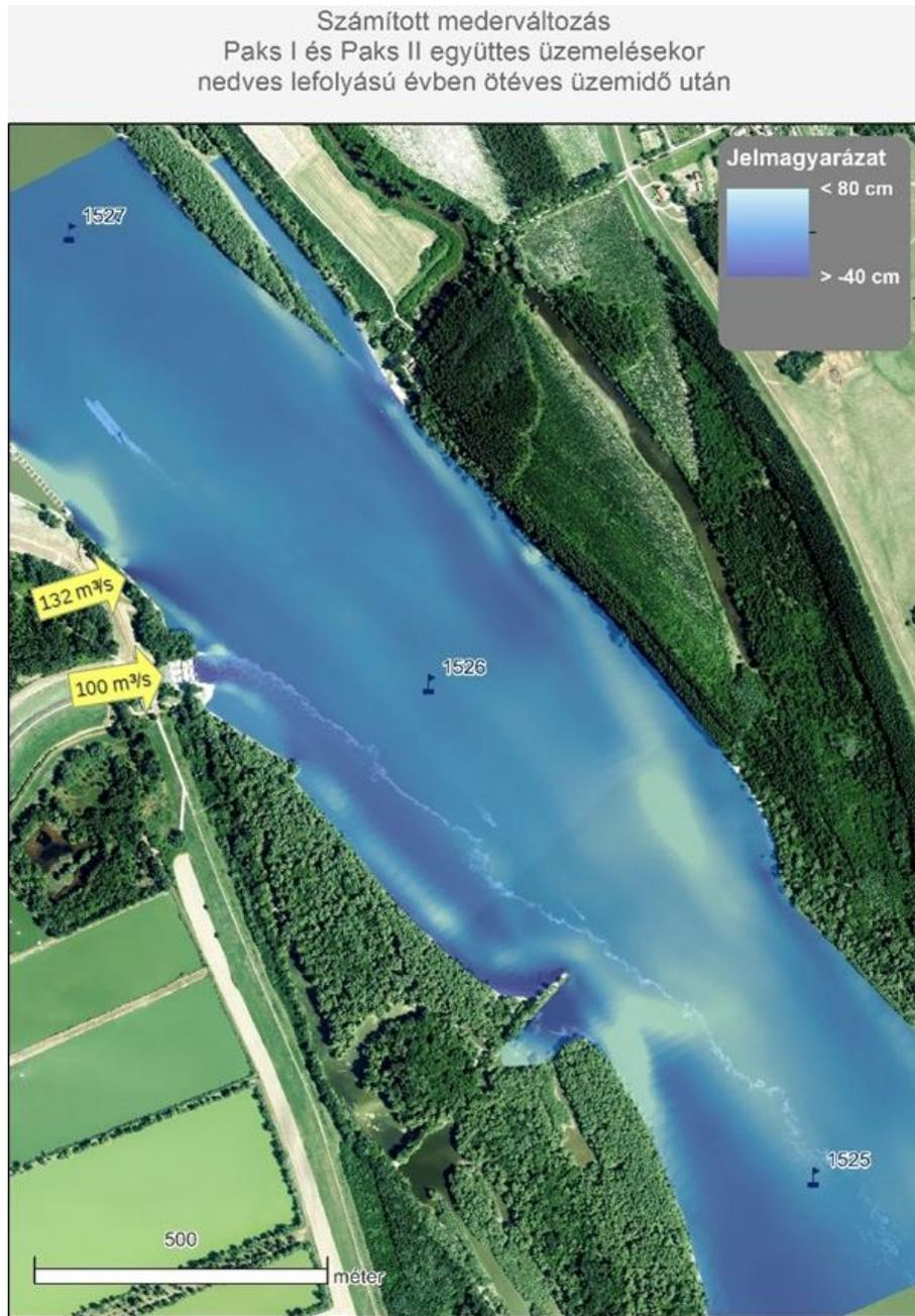
Számított mederváltozás Paks I és Paks II együttes üzemelésekor nedves lefolyású évben öt éves üzemidő után – Calculated morphology changes during the joint operation of Paks I and Paks II in wet hydrological year after five years of operation
