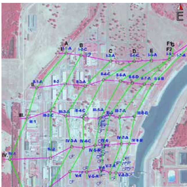
A telephely talajmechanikai feltárásának helyszínrajza
