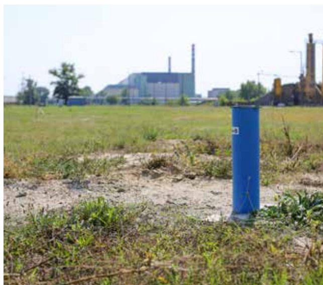
Hidrodinamikai vizsgálatok céljából telepített figyelőkutak (középső és lenti kép)
