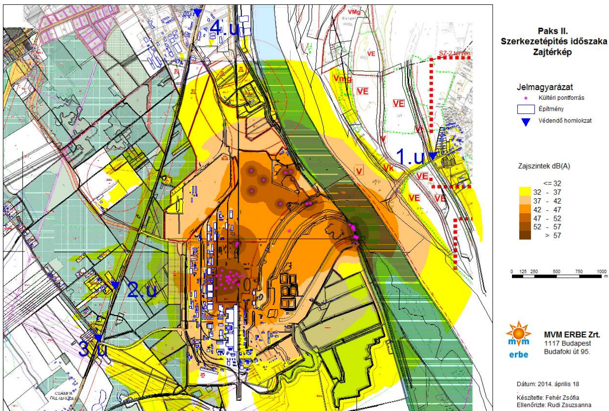
15.4.2-4. ábra: Zajterhelés a szerkezetépítés időszakában [15-9]
