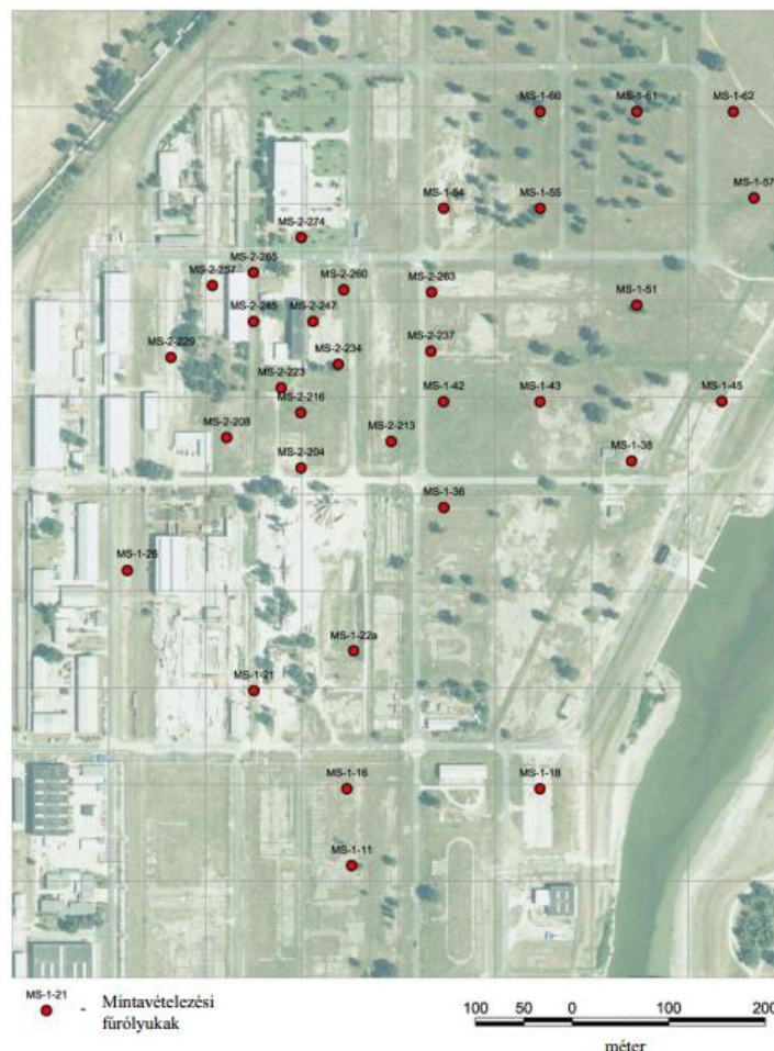
4.6-2 ábra: A fúrólyukak elhelyezkedése a telephelyen
