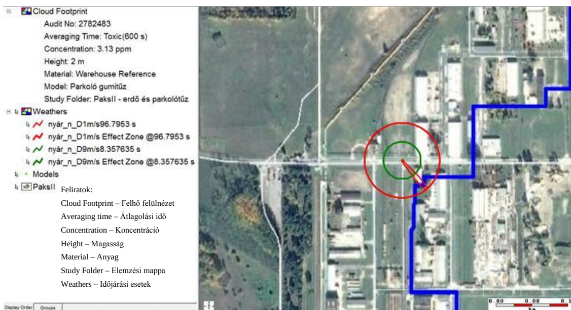
2.2.2-5. ábra: A gumitűz okozta füstfelhő ERPG-2 koncentrációjának távolságfüggése
