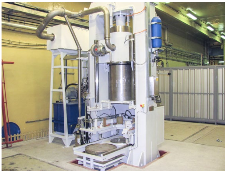
Radioaktív hulladék-tömörítő berendezés | forrás: a Paksi Atomerőmű hulladékkezelési szakterületének kollégái által készített saját kép
