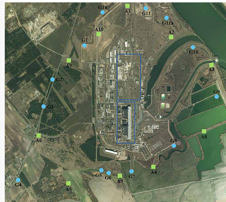
Az „A” és a „G” típusú távmérő állomások elhelyezkedése a meglévő és az új atomerőművi blokkok körül az állomáshálózat bővítése után.
